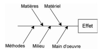
Les causes peuvent être réparties selon la méthodes des 5 M (ou davantage, selon les versions), comme ci-dessus. Cet outil est utilisé dans le cadre des cindyniques tant pour l'analyse *a posteriori* du déroulement d'ENS (en vue de constituer une base d'expérience exploitable) que pour l'analyse *a priori* du risque (phase d'identification du risque de la
